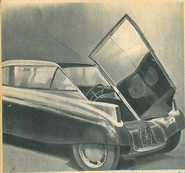
Sulla Regina 1950, il motore è posto con minimo ingombro sotto la parte anteriore, consentendo così l'accesso anteriore o posteriore (bagagliaio). Nell'interno spazioso, un sedile per ogni passeggero.
