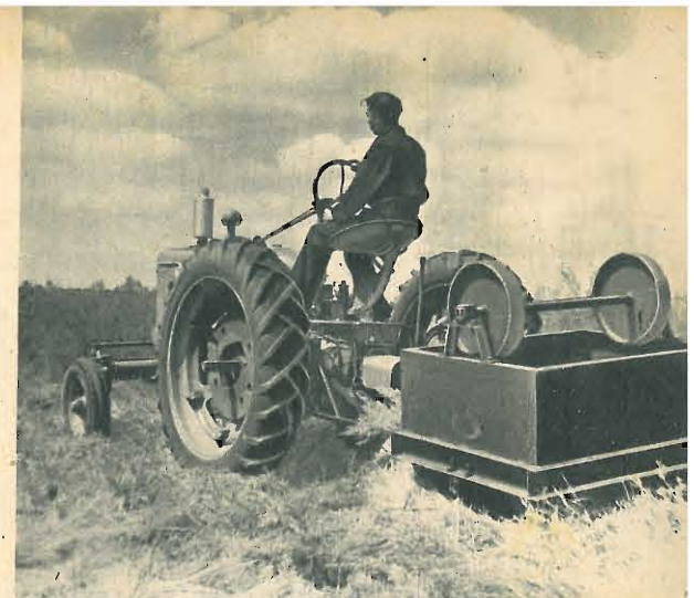
Macchina adoperata nella foresta delle Lande per ripulire sia il sottobosco sia le trincee anticendio.
